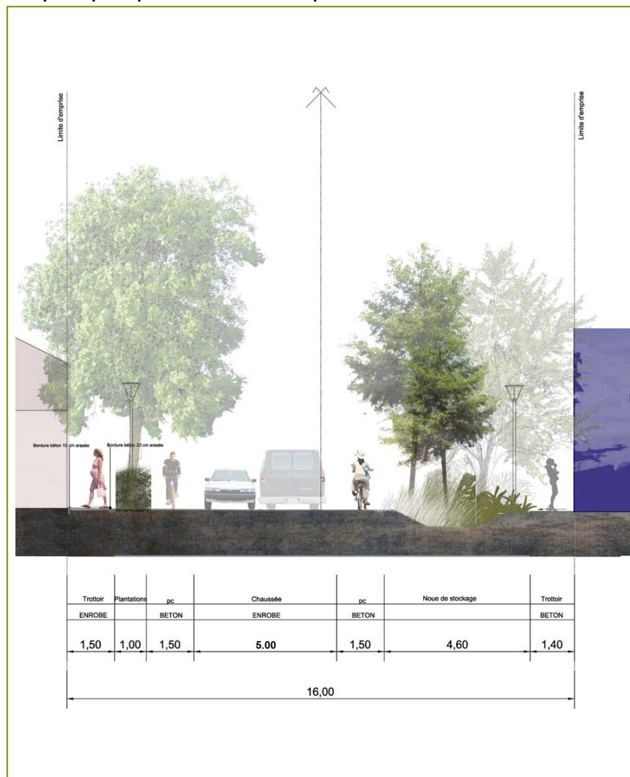
Coupe de principe sur une voie inter-quartiers.
